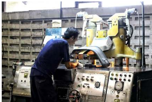
Gambar 2. 7 Proses curing pada ban
