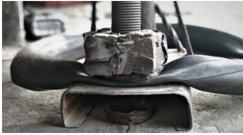
Gambar 3.7 jepitan ban dalam menggunakan alat press
