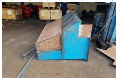
Gambar 2. 2 Inlet Chute yang sudah di ruangan maintenace
