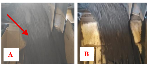
Gambar 3. 2 Gambar (A) aliran flowrate sebelum dimodifikasi dan gambar (B) sesudah modifikasi
