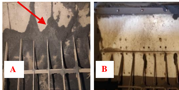
Gambar 3. 5 gambar (A) sebelum menggunakan polyethylene dan gambar (B) sesudah menggunakan polyethylene
