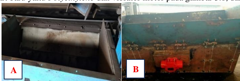
Gambar 3. 1 Gambar (A) polyethylene yang sudah dipasang dan Gambar (B)Vibrator motor yang sudah dipasang
