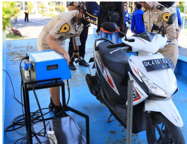
Gambar 2.1 Kegiatan Uji Emisi Gas Buang[4]
