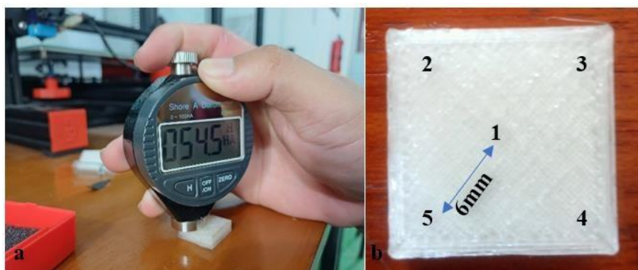
Gambar 7. Pengujian keketrasa (a) Proses pengujian (b) Plustrasi titik pengujian.
