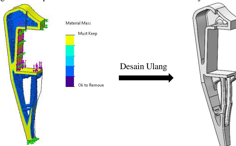
Gambar 6. Hasil Optimasi Topologi dan Desain Ulang
