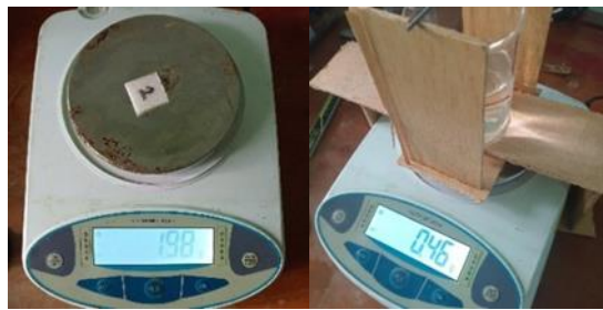
Gambar 2.13 Pengujian Densitas : (kiri) Penimbangan Berat di udara, (kanan) Penimbangan Berat di air
