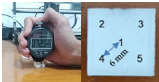
Gambar 2.12 Pengujian Kekerasan: (kiri) Pengujian menggunakan Durometer Digital Shore A, (kanan) Ilustrasi titik pengujian
