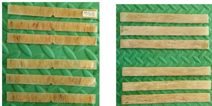
Gambar 4 Hasil pembuatan spesimen uji impact dan uji tarik.
