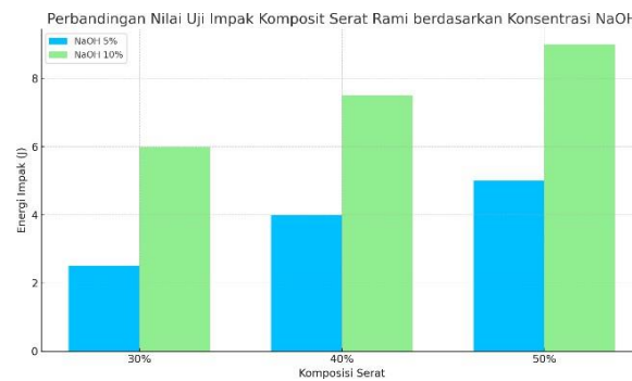
Gambar 8 Grafik hubungan antara variasi fraksi volume dan kosentrasi NaOH dengan energi impak.
