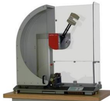
Gambar 6 Mesin uji standar impact ASTM 6110 [8].
