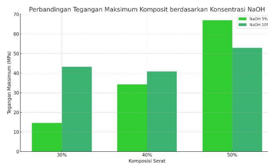
Gambar 11 Grafik hubungan antara variasi fraksi volume dan kadar NaOH dengan tegangan maksimalnya.
