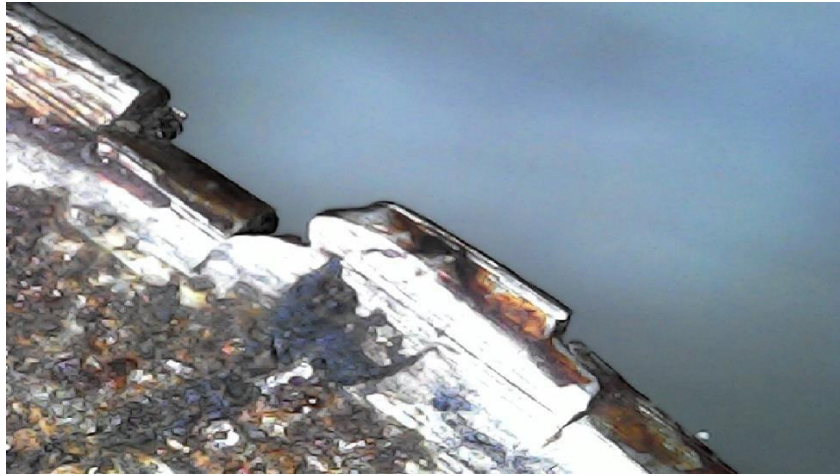
Gambar 4 Pola Patahan Impeller Pompa Ash Disposal yang Terkena Abrasi
