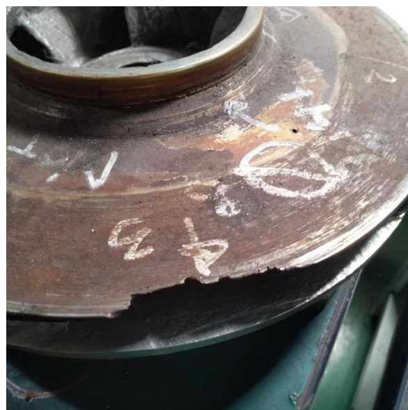
Gambar 2 Impeller Pompa Ash Disposal yang mengalami kegagalan
