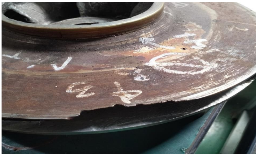
Gambar 3 Permukaan Abrasi Impeller Pompa Ash Dishposal
