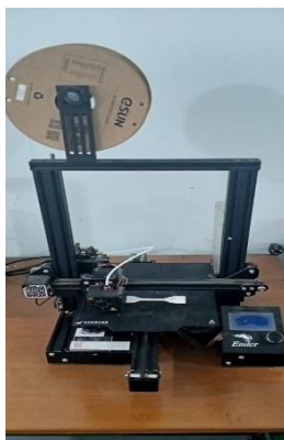
Gambar 3. Proses pembuatan spesimen uji dengan menggunakan mesin 3D Printing
